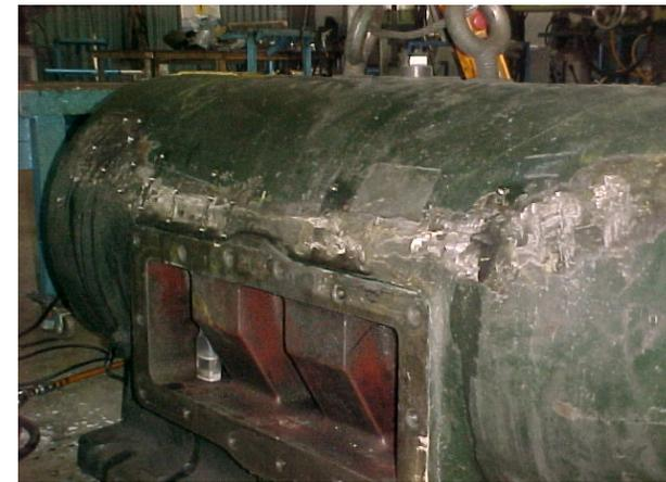
機密維持(漏水防止)と強度補強が必要部位「パッチ当て修理」
